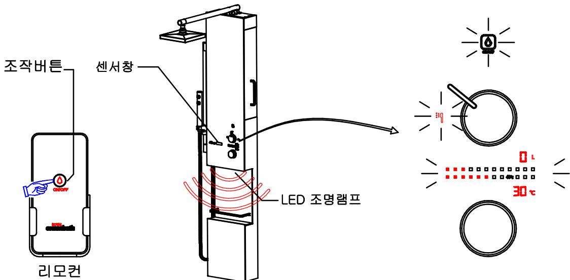
※ 사용준비 상태(조작/조절부 표시램프 및 LED 조명램프 점등상태)에서 샤워본체 전면에서 사용자가 떠나면(사용자가 없으면) 약 10초 후 자동으로 조작/조절부 및 조명램프가 깨지면서 사용준비 상태가 해지 됩니다.
